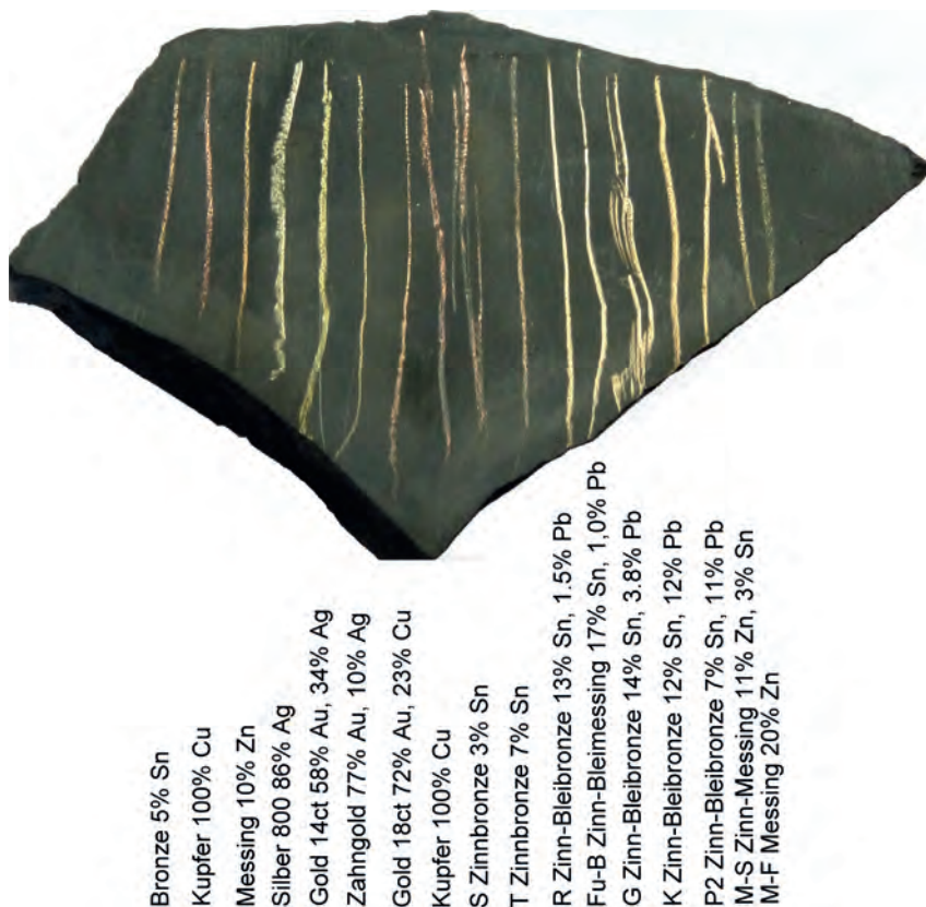
Abb. 4 Der im archäologischen Experiment verwendete Proberstein aus schwarzem Mergelschiefer mit den frischen 17 Strichproben (Proberstriche siehe Abb. 5). Breite 96 mm.
