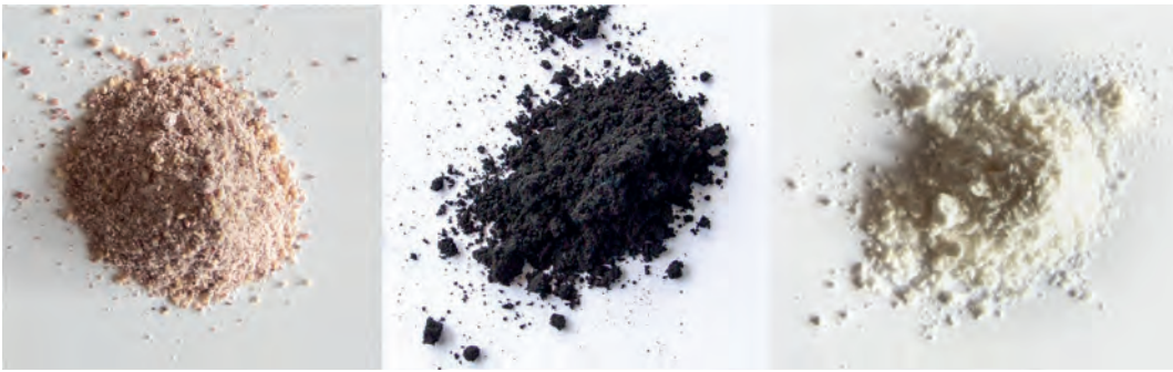
Abb. 6 Der in den Experimenten verwendete Weinstein als Flussmittel: links: Naturprodukt; Mitte: Naturprodukt gebrannt; rechts: synthetisch hergestellter Weinstein..
