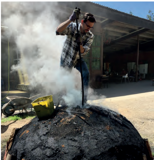
Abb. 2 Ein Meiler braucht während des gesamten Brennprozesses viel Aufmerksamkeit. Zu Beginn muss er regelmässig mit frischer Holzkohle versorgt werden, damit die Glut im Inneren nicht erlischt.
