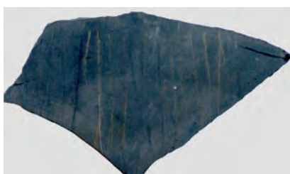
Abb. 7 Proberstein von Abbildung 4 (Auflösung: Abb. 5), nach einstündigem Einlegen in 70° C heisser Sodalösung.
