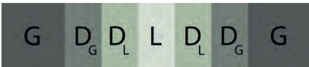
Abb. 2 Die Diffusionszonen. G: Grundwerkstoff (Kupfer, Bronze usw.); L: Lot. Bei der Diffusionszone DL diffundiert der Grundwerkstoff in das flüssige Lot und bei DG umgekehrt. Beim Abkühlen bleiben diese Schichten bestehen und die Werkstücke sind über diese stoffschlüssig verbunden.
