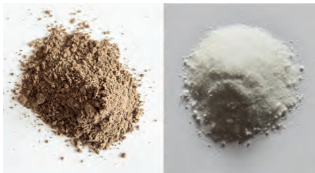
Abb. 4 Die in den Experimenten verwendete Pottasche als Flussmittel: links: experimentell hergestellt; rechts: synthetisches Produkt.
