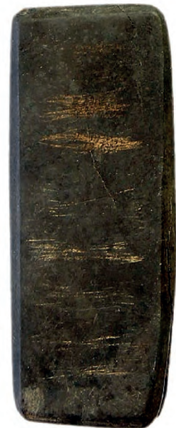
Abb. 2 Beispiel eines Probersteins, auf dem sich die Edelmetall-Abstriche erhalten haben. Fund aus der «Bergbaustadt» Freiberg/D, Mittelalter.
