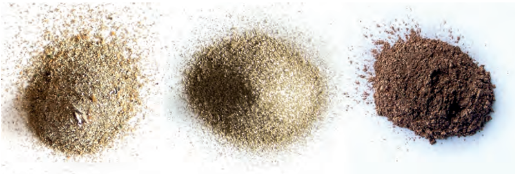
Abb. 7 Die in den Experimenten verwendeten Streulote: links: Silberspäne; Mitte: Cu-Ag-Späne; rechts: Cu-Ag-Pulver.
