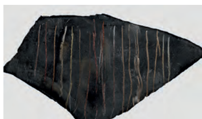
Abb. 6 Proberstein von Abbildung 4 (Auflösung: Abb. 5), nach 14-stündigem Einlegen in Weinessig.
