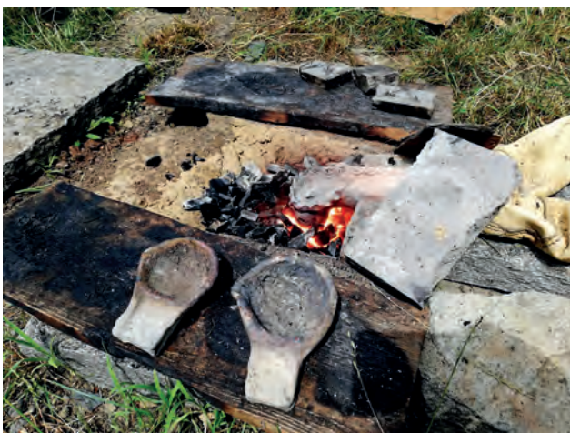
Abb. 3 Mit der zusätzlichen Luftzufuhr durch die Tondüse mittels Blasebälgen erreicht der glühende Gussofen Temperaturen bis 1200 °C. Im Vordergrund zwei Gusstiegel aus Keramik.
