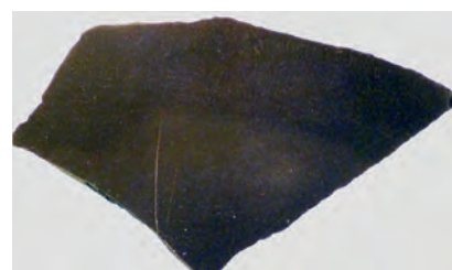
Abb. 8 Proberstein von Abbildung 4, nach der Reinigung mit einer heissen Wasser-Weinsteinlösung.
