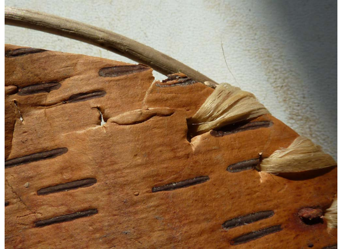
Abb. 6 Beim Versuch, um die Außenkante einen Verstärkungsring anzunähen, bricht die Rinde.
