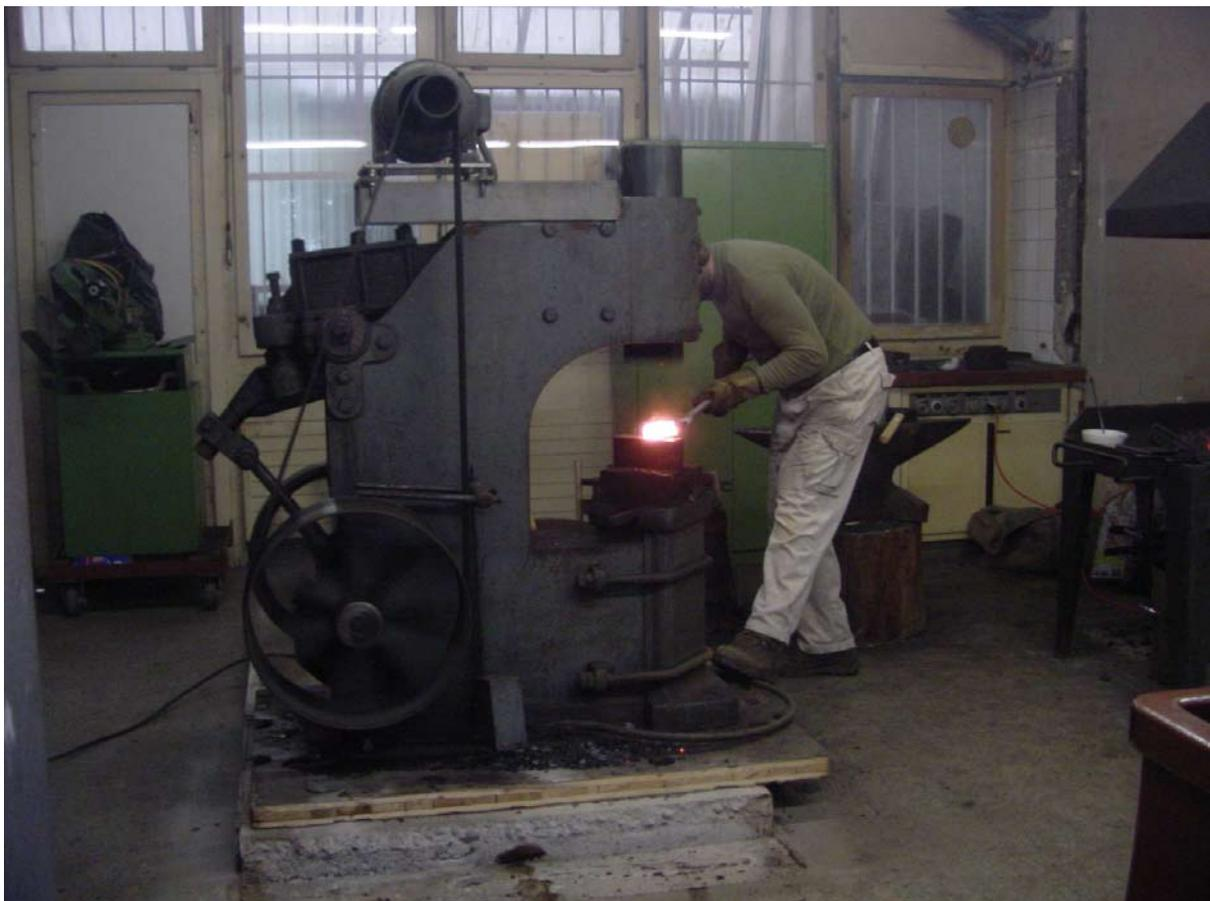
Abb. 2. Die Schmiede ist mit Amboss, Esse und Federhammer ausgerüstet. Aufnahme während der Projektwoche Damast 2004.
