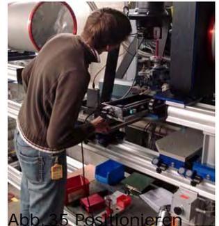
Abb. 35 Positionieren der Münzen auf dem Drehteller der ICON-Anlage durch einen Mitarbeiter des PSI.
