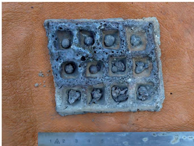
Abb. 15 Eine Tüpfelplatte nach dem Schmelzvorgang. Das Metall ist grösstenteils zu Kugeln zusammenschmolzen, die Zwischenstege der Tüpfelplatte sind verglast.
