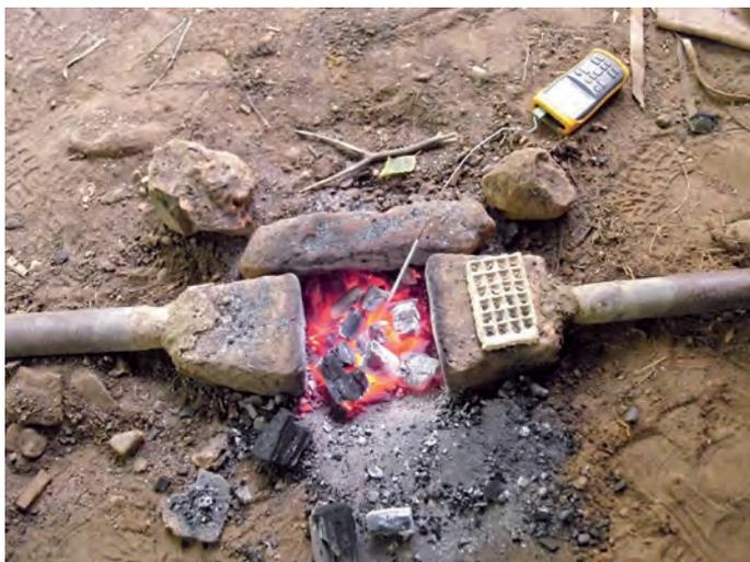
Abb. 14 Der Schmelzofen mit der Luftzufuhr über zwei sich gegenüberliegende Düsenziegel.
