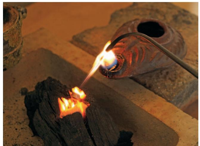
Abb. 6 Auflöten eines Silberbleches mit Hilfe der umgelenkten Flamme einer Öllampe.
