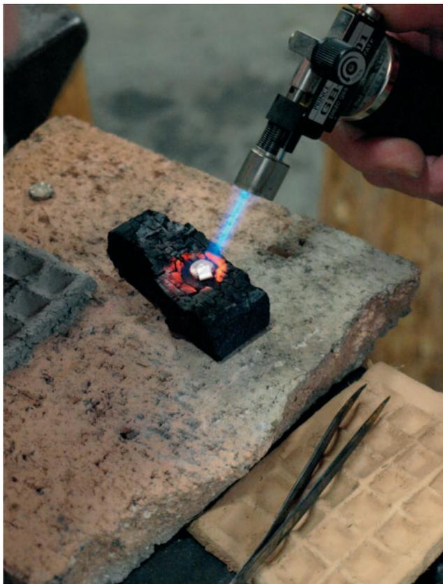
Abb. 5 Erste Versilberungsversuche mit einem modernen Gasbrenner.
