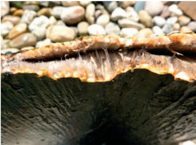
Abb. 3 Bei weiteren Biegeversuchen mit dem zweiten Rindenstück rissen auch die Bast-schichten.
