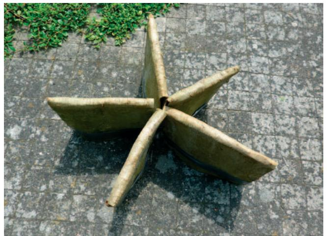
Abb. 6 Beim Umbiegen gleich nach dem Abziehen der Rinde vom Baum war die Borke nicht gebrochen.
