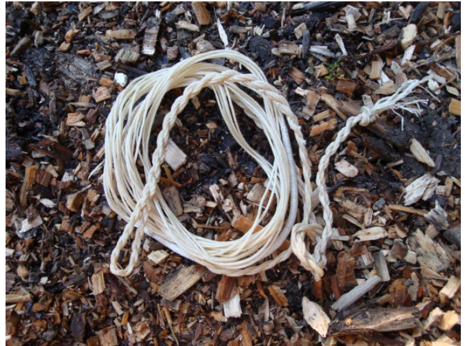
Abb. 17: Leinenfaden . Mehrere Leinenfäden werden zusammen gezwirnt und ergeben eine sehr reissfeste und feine Bogensehne. Erlaubt verhältnismässig schnelle und weiche Abschüsse. Der verwendete Leinenfaden wurde maschinell hergestellt. Es fehlt der Vergleich mit einem von Hand gesponnenen Leinenfaden.
