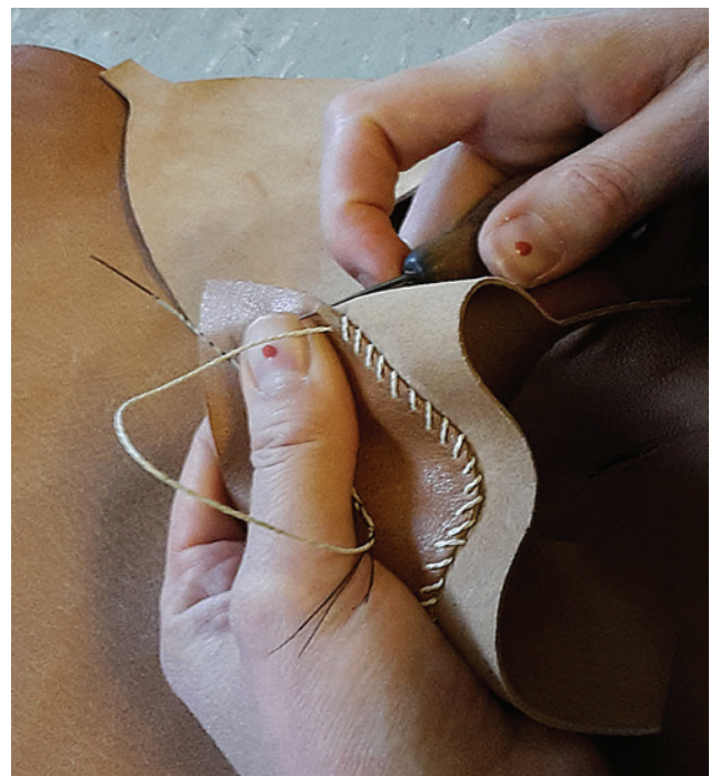
Abb. 2 Mit Ahle und Faden wird auf der Innenseite des Schuhs eine Verstärkung beim Fersen angenäht. Als „Nadel“ dient eine Wildschweinborste.
