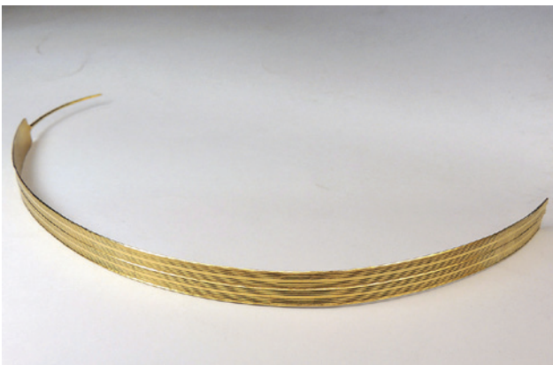
Abb. 15 Das vorgefertigte Band wird in ein gerilltes Gesenk geschmiedet, dadurch entstehen die Rippen auf seiner Aussenseite und es erhält seine endgültige Länge.
