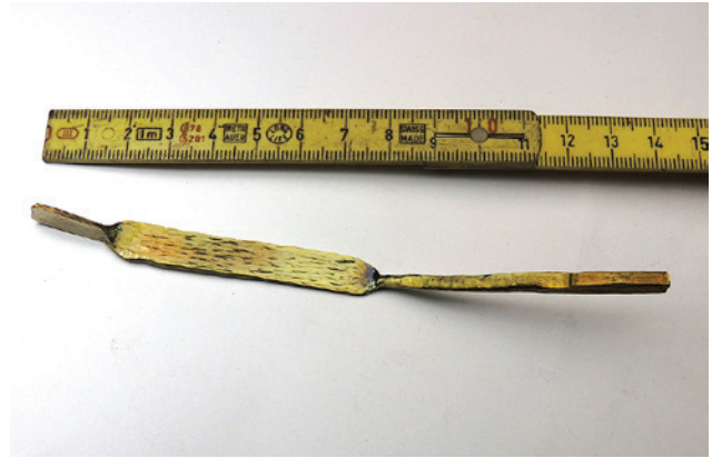
Abb. 2 Der Barren wird zuerst etwas in die Länge geschmiedet, dann die drei Segmente für Nadel, Bügel und Fuss voneinander abgesetzt und in die jeweilige Richtung ausgeschmiedet.
