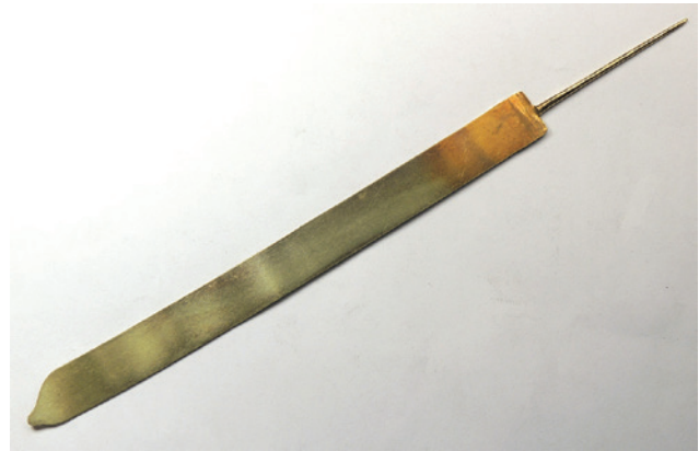
Abb. 14 Dieser Barren wird zum Band ausgeschmiedet (hier gewalzt).
