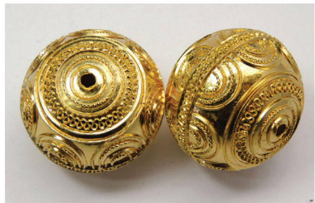
Abb. 12 Zwei fertige Kugeln mit dem schönen Glanz, den die Goldoberfläche durch das Reaktionslotverfahren erhält.
