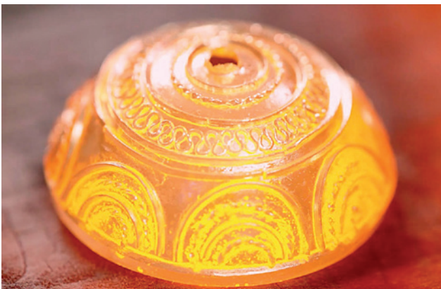
Abb. 11 Eine Halbkugel beim Reaktionslötten in der Löthitze. Die Drahtauflagen müssen vor dem Lötten so angepasst werden, dass sie mit der Kugeloberfläche Kontakt haben, andernfalls kommt keine Lötverbindung zustande.
