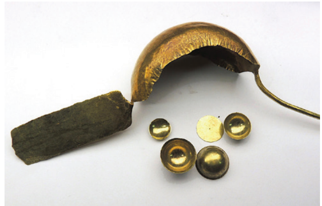
Abb. 4 Der Bügel ist fertig ausgeschmiedet und gewölbt. Die an der Seite sichtbaren Stauchbereiche sind auch an der Originalfibel vorhanden. Aus einem zweiten Blechstück sind Rondellen ausgeschnitten und zu Halbkugeln aufgetieft worden, die später die Kugel am Fussende und die Halbkugel am Übergang Bügel – Nadel bilden.
