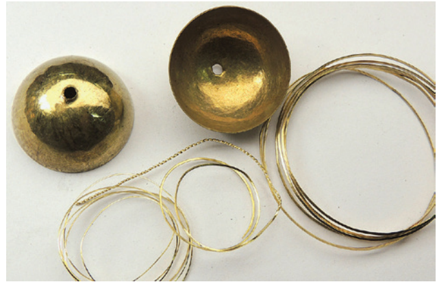
Abb. 8 Die zwei Halbkugeln müssen exakt die gleiche Grösse haben, damit sie zur Kugel verlötet werden können. Runddraht von 0,5 mm Durchmesser erhält in einem Gesenk einen dreieckigen Querschnitt. Durch Tordieren verändert sich seine optische Wirkung.
