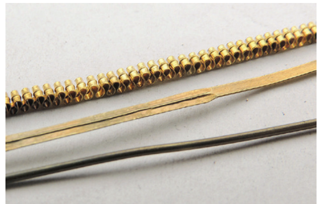
Abb. 16 Die Schlaufenbänder entstehen aus Draht. Dieser wird flach geschmiedet, in ein gerilltes Gesenk geschlagen und zum Schlaufenband geformt. Breite 2 mm.
