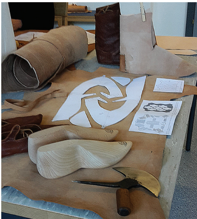
Abb. 1 Das Halbmondmesser und Schuhleisten sind wichtige Werkzeuge bei der Schuherstellung. Im Hintergrund ein ausgelegtes Schnittmuster eines Frauenschuhs aus dem Spätmittelalter.
