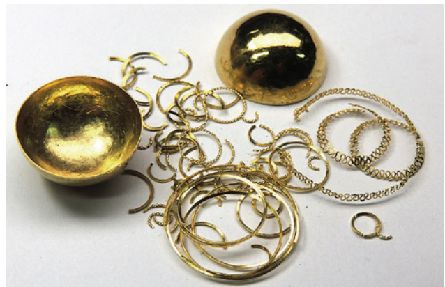
Abb. 10 Die vorgeformten Drahtstücke bereit zum Auflegen auf die Halbkugeln. Insgesamt wird auf die Kugel von 23 mm Durchmesser etwa 1,2 m Golddraht aufgelötet.
