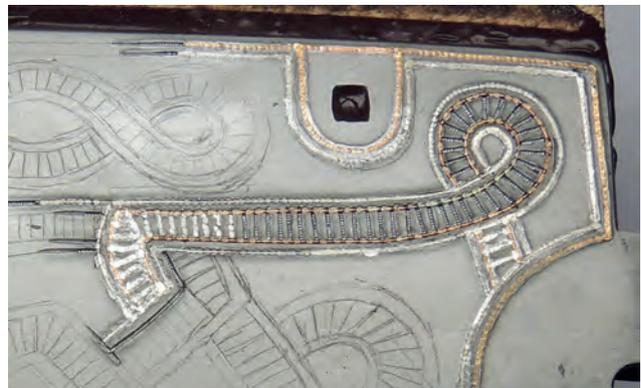
Abb. 12 Mit leichten Punzschlägen werden die Drahte in die Rillen gepresst und darin fixiert. Für die Nachbildung wurden aus Gründen der Zeitersparnis keine tordierten, sondern gezogene Drahte verwendet. Die Silberdrahte bestehen aus Ag97Cu3, die Messingdrahte aus einem niedriglegierten Messing mit ca. 20% Zink. Der Durchmesser der Drahte muss exakt auf den Rillenquerschnitt abgestimmt sein, damit ein Halt in der Rille zustande kommt.
