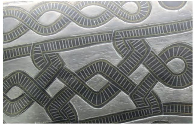
Abb. 16 Durch Überarbeiten mit dem Planierpunzen, Überschleifen und Verreiben mit dem Polierstahl entsteht eine geschlossene Silberfläche. Diese ist weniger als 1/10 Millimeter dick.
