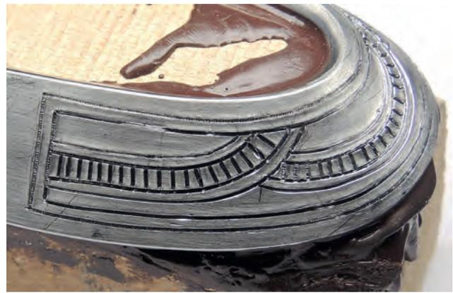
Abb. 11 Mit einem Punzen sind die Rillen für die Drahteinlagen in der Eisenoberfläche geöffnet. Da der Punzen Material verdrängt sind die Ränder der Rillen seitlich etwas aufgeworfen, was das Fixieren des Drahtes darin erleichtert. Der Grund der Rille ist teilweise mit einem Zahnpunzen aufgeraut, damit der Draht beim Einlegen weniger zur Seite ausweichen kann.
