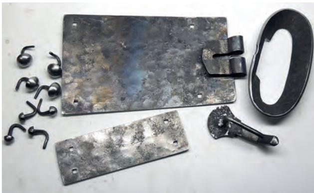
Abb. 9 Die Einzelteile (Rückseite) der rekonstruierten Gürtelgarnitur sind aus modernem Blankstahl geschmiedet. Ihre beim Tragen sichtbaren Oberflächen werden blank geschliffen.
