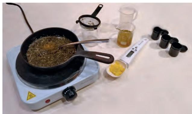
Abb. 2 Herstellungsschritte im modernen Verfahren (Mazeration, Verdampfung, Trennung plus Wachsugabe).
