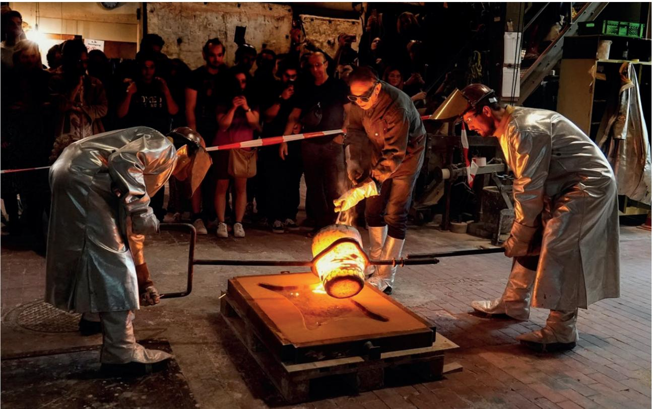
Abb. 6: Der Guss eines Ochsenhautbarrens in der Kunstgiesserei St. Gallen. Als Form kam hier eine moderner, mit Giesser-sand gefüllter Formkasten zur Anwendung. Von antiken Funden weiss man, dass früher diese Barren in grossen Steinfor-men oder in Sandgruben gegossen wurden.
