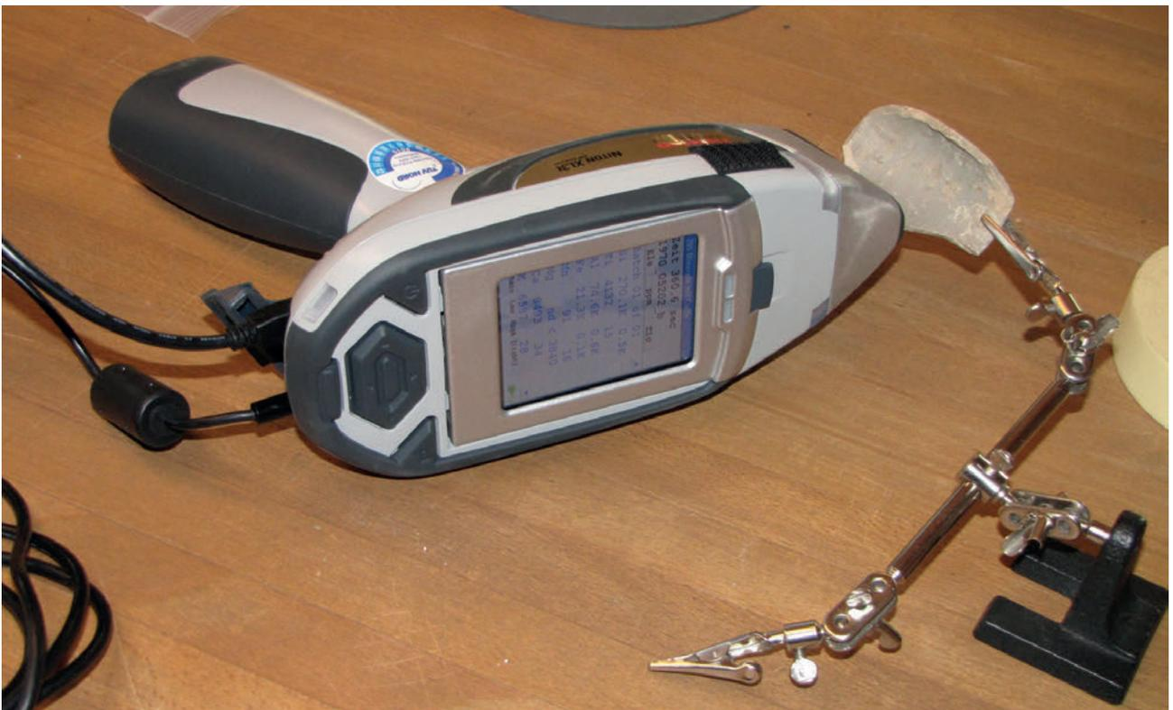
Mobiles Röntgenfluoreszenz-Analysegerät «Niton», hier mit vorgehaltener Keramikscherbe (rechts). Auf dem Display erscheinen nach kurzer Messzeit die Anteile der detektierten Elemente in Prozent oder in ppm (parts per milion). Solche Geräte haben – gut kalibriert und professionell eingesetzt – noch grosses Potential in Museen und sogar auf Ausgrabungen.
